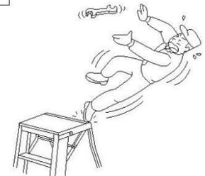
**警告** 在作业时需移动作业台时，请务必下作业台后再进行移动。
